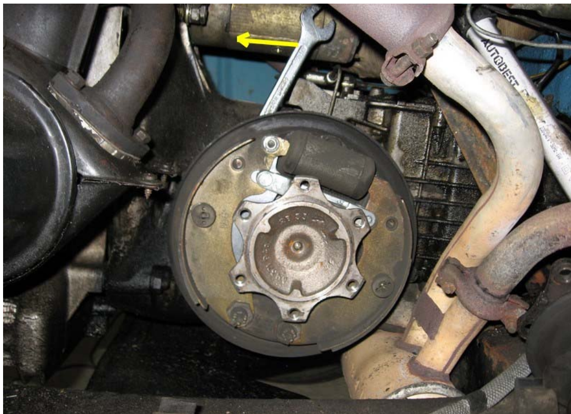
8 - Dévisser le cylindre de roue (clé de 10) et le sortir sur l'avant
