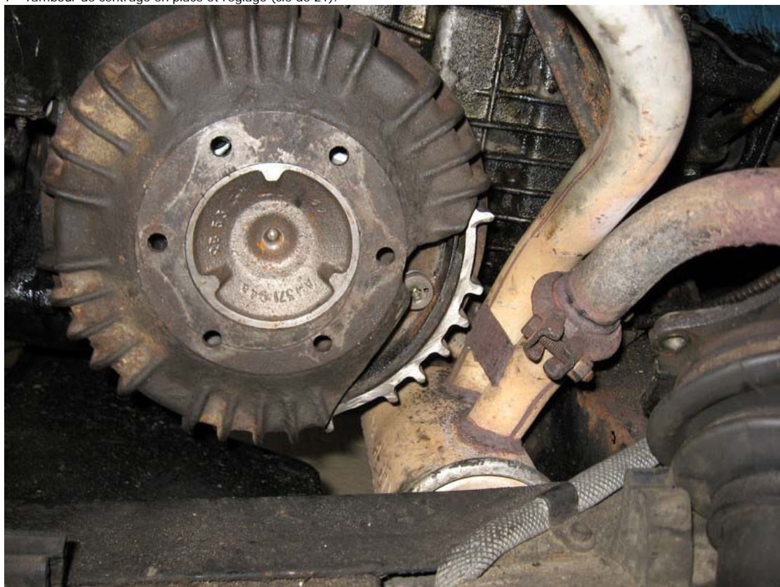
7 - Tambour de centrage en place et réglage (clé de 21).
