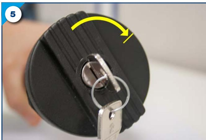
4. Verrouillez le bouchon à l'aide d'une des clés fournies, le couvercle noir doit alors tourner librement. Votre bouchon antivol est ainsi posé (photo 6).
