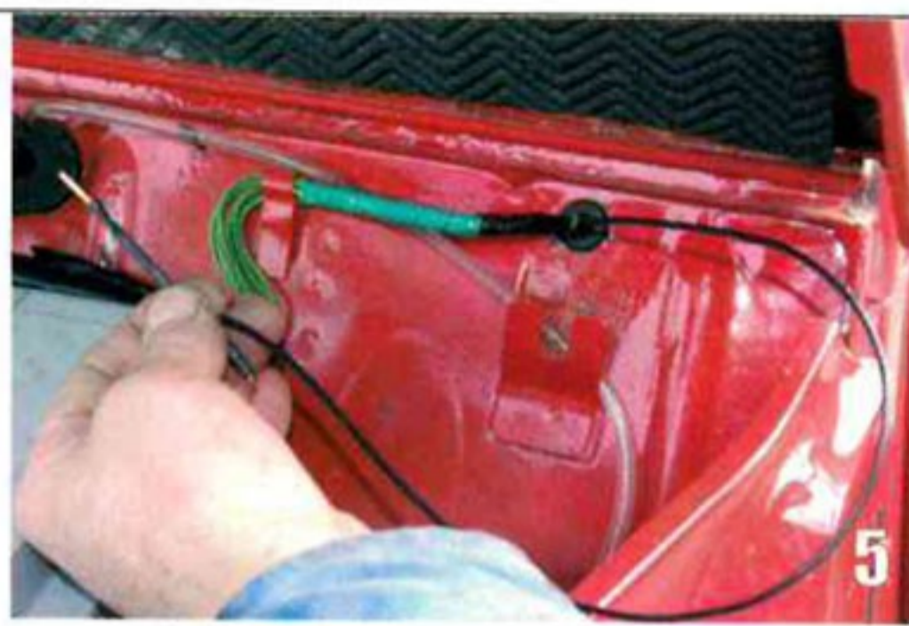
5 Passez le fil noir en Y du kit à travers le tablier, le long du faisceau qui va vers l'arrière de la voiture.
