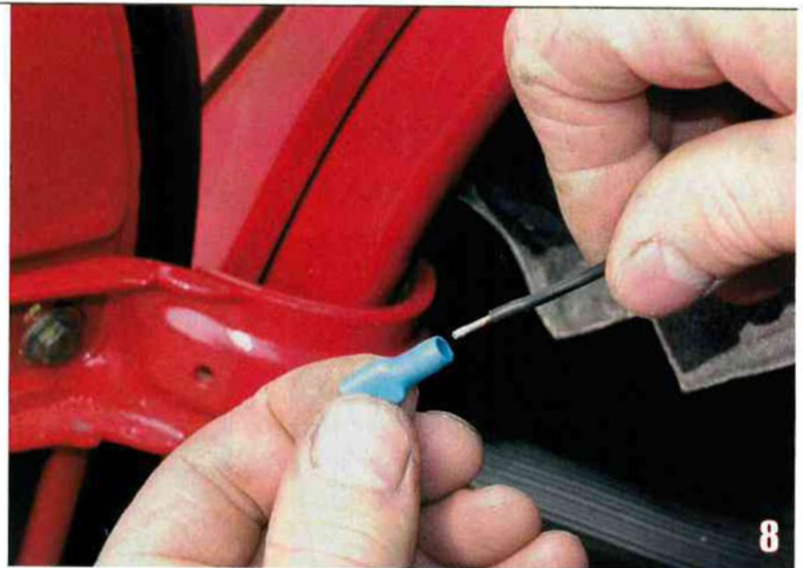
8 Côté habitacle, mettez une cosse sur l'autre extrémité du fil noir en Y.
