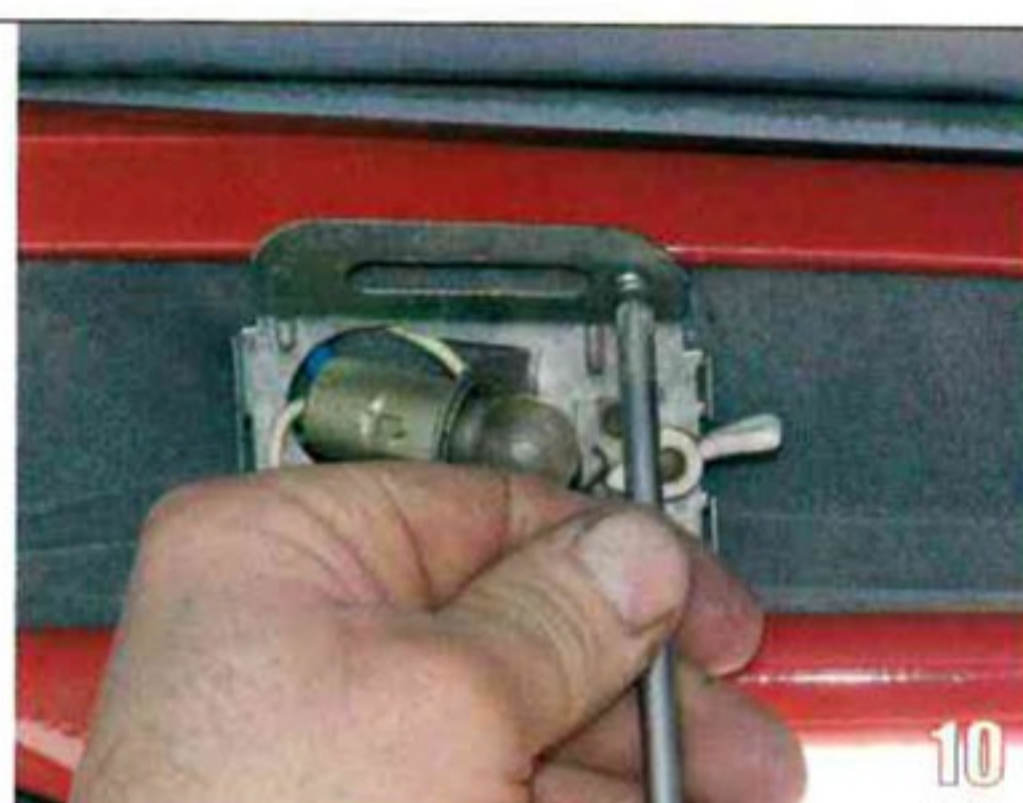
10 Dévissez le support (tournevis cruciforme) et ne perdez pas la vis.
