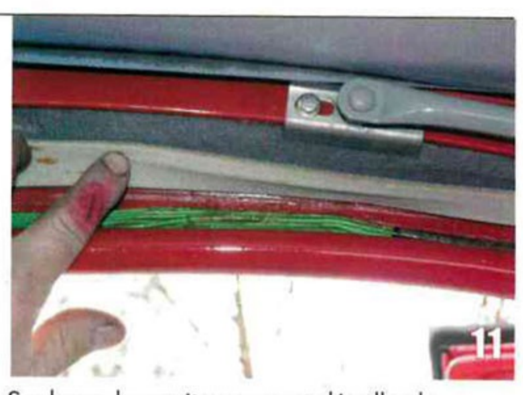
11 Soulevez le capitonnage et décollez-le légèrement pour voir apparaître le faisceau qui va vers l'arrière.
