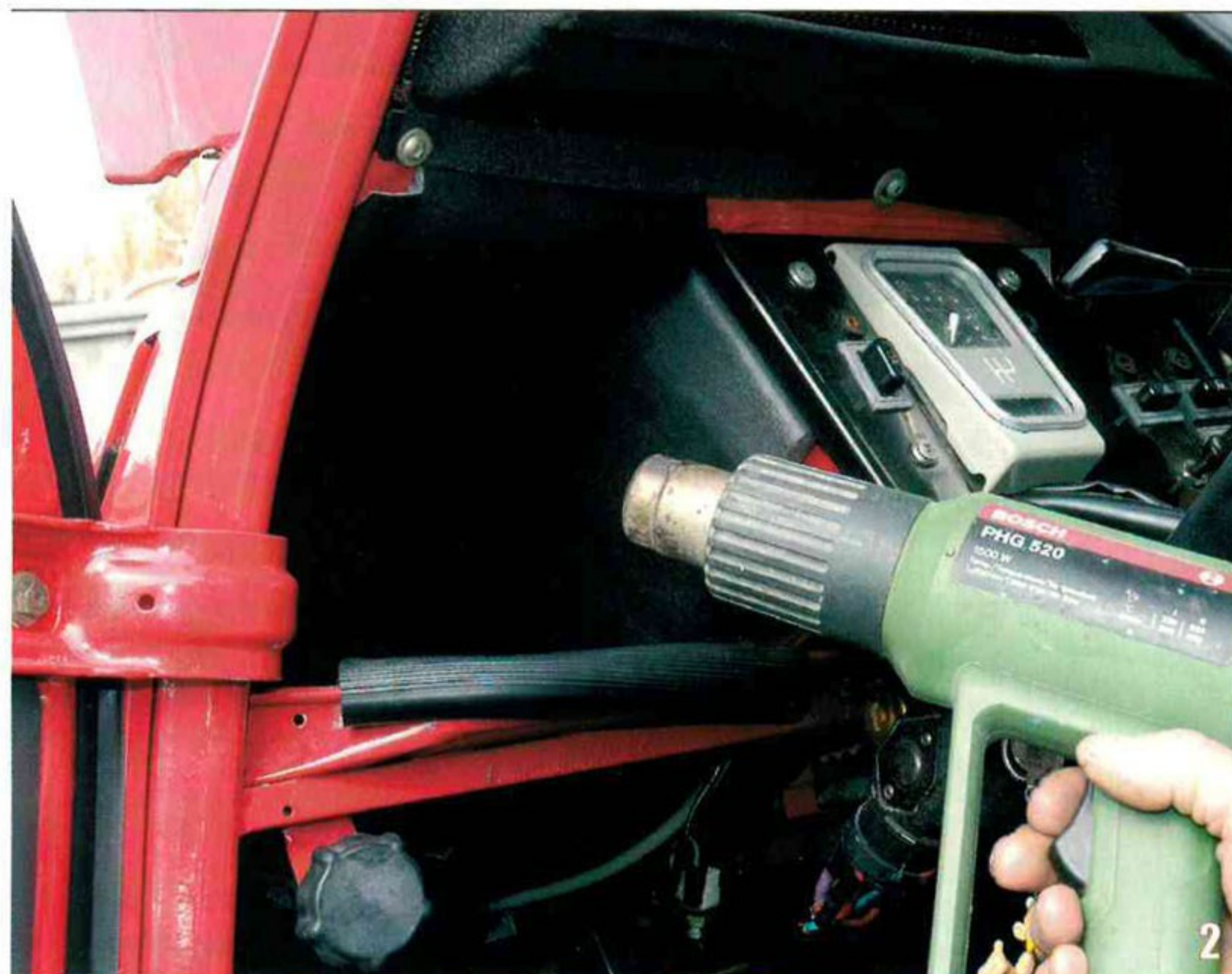
Avec une lance thermique ou un sèche-cheveux, ramollissez le capitonnage d'origine qui est collé, cela pour éviter de le casser quand vous le tordrez.
