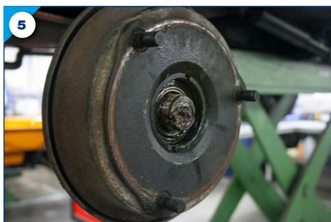
**2.** Desserrez les excentriques d'un quart de tour vers le bas à l'aide d'une clé plate de 14 mm afin de placer ces derniers en position basse (photo 6). Présentez l'extracteur de tambour (photo 7). Posez les écrous de roue sur les goujons afin de maintenir ce dernier (photo 8). Puis, à l'aide d'une douille de 19 mm et d'un cliquet, serrez l'écrou de la tige filetée (photo 9) pour déposer le tambour (photo 10).
