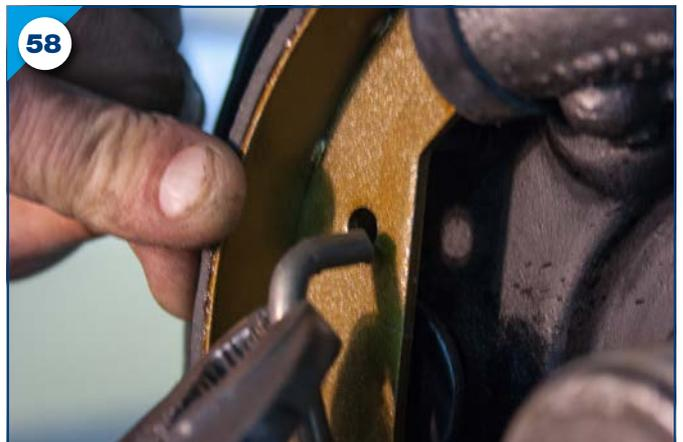
**11.** Présentez le ressort de rappel en faisant passer ce dernier par le pontet de maintien (photo 56), placez un premier embout de celui-ci dans la première mâchoire (photo 57), et à l'aide d'une pince multiprise placez l'autre extrémité du ressort dans la seconde mâchoire (photo 58). Le ressort de rappel est ainsi posé et le tambour est prêt à être remonté (photo 59).
